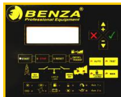
Fig.2 Controlerul digital al panoului de transfer sarcina
